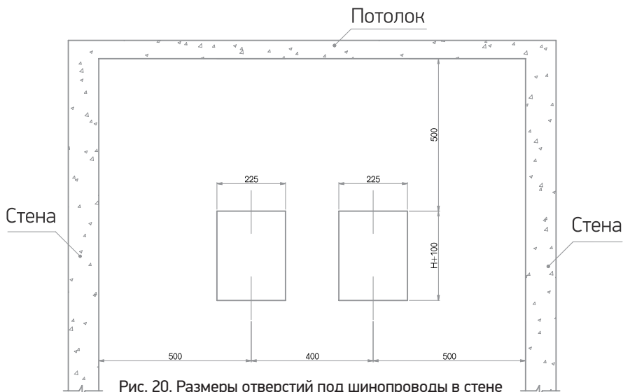
Рис. 20. Размеры отверстий под шинопроводы в стене
